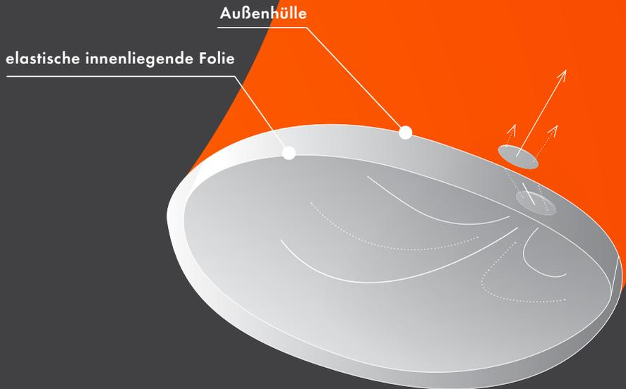
**DER SELBSTHEILENDE DUO PROTECT SCHWIMMKÖRPER MACHT DIE SURVIVAL 275 Duo Protect DANK UNSERES PATENTIERTEN SYSTEMS ZU EINEM DER SICHERSTEN RETTUNGSMITTELN FÜR ANGLER.**
