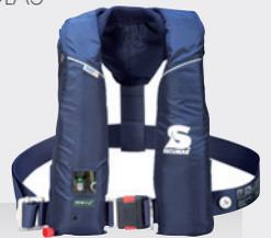
Aufblasbare Universal-Rettungsweste mit Spitzentechnologie nach SOLAS für den universellen Einsatz in industriellen und gewerblichen Bereichen, für Binnen- und Seeschifffahrt. Der patentierte 3D Schwimmkörper sorgt mit zwei tetraederförmigen Luftkissen für einen großen Hebelarm, der den Körper im Wasser in Rückenlage dreht.
